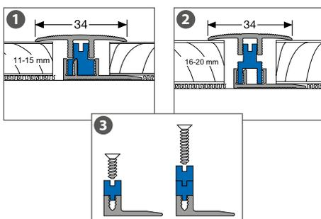
Zur Basisprofilerrhöhung für Clipprofil oder Schraubprofil
