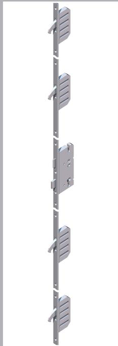
**STV-M4 5-fach:** Massivschwenkriegel aus Stahl greifen tief in die Schließleiste ein und hinterkrallen sich im Rahmen. Massive Bauteile und exakte Fertigung sorgen für eine leichtgängige Schließmechanik und garantieren dabei eine höchstmögliche Verriegelungskraft, die fast allen Einbruchwerkzeugen trotz.
